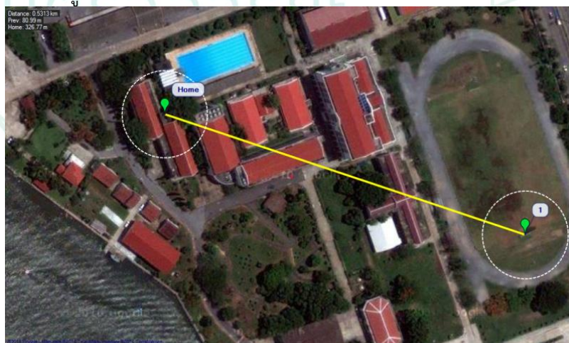
รูปที่ 1 การหาแบร์ริงและระยะทางระหว่างพิกัดละติจูด/ลองจิจูด 2 จุดใด ๆ บนพื้นโลก
