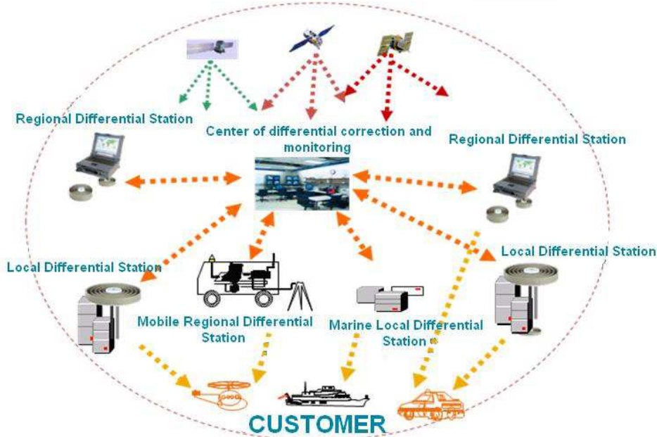
รูปที่ 4-3 : โครงสร้างพื้นฐานทางภาคพื้นดินสำหรับระบบนำร่องของดาวเทียมที่มีความแม่นยำสูง 1
